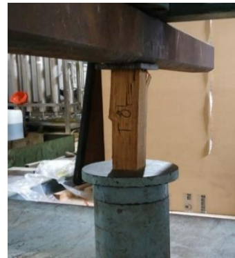
Gambar 4.3. Benda Uji Kuat Tekan Balok Laminasi Bambu
