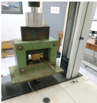
Gambar 4.5 Benda Uji Geser Balok Laminasi Bambu
